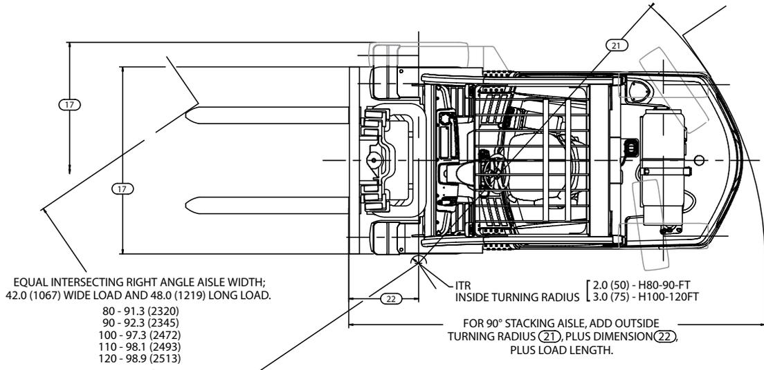
EQUAL INTERSECTING RIGHT ANGLE AISLE WIDTH;
